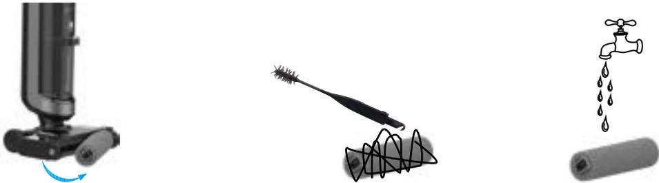
1. Pulse el botón en el lado izquierdo del dispositivo y retire el cepillo cilíndrico.
