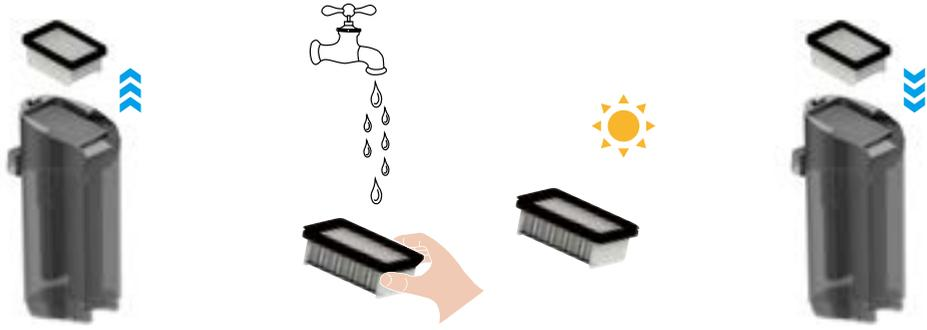
1. Retire el filtro HEPA de la parte superior del cubo de agua sucia.
